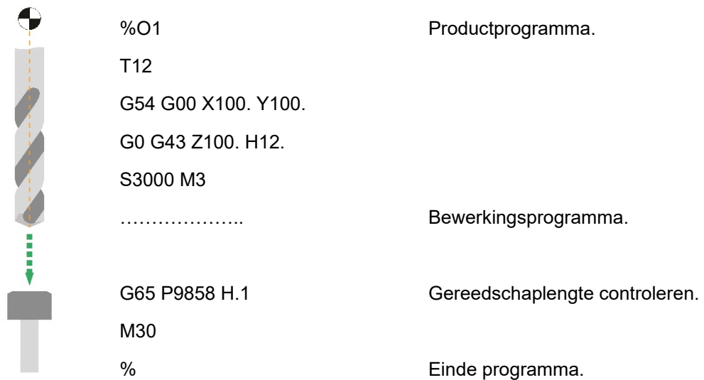
Figuur 6.2 Een boor controleren
